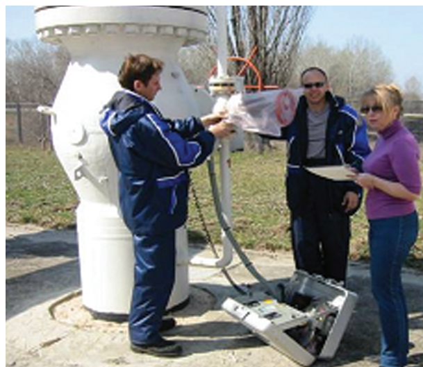
С помощью замера максимального расхода газа техники подсчитывают интенсивность утечки метана на компрессорной станции Черкасытрансгаза.
